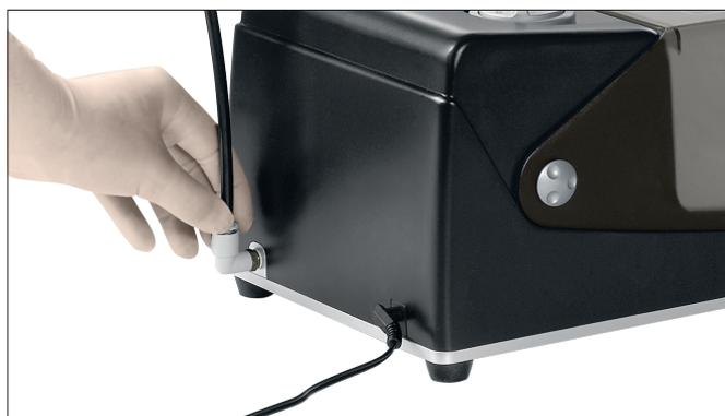
Remplir le réservoir d'huile avec l'huile d'entretien Synthes, 40 ml, pour EPD et APD (05.001.095), conformément aux instructions du chapitre Entretien et maintenance.
