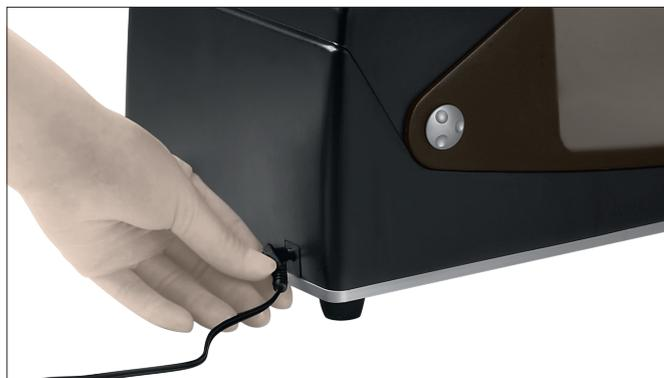
Brancher l'extrémité de la connexion pneumatique sur le connecteur d'air situé à l'arrière du module, puis connecter le mamelon de la connexion pneumatique à l'alimentation en air. Régler la pression de l'alimentation en air sur 5–10 bars.
